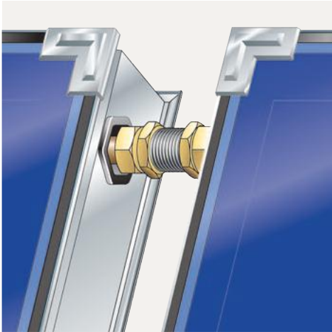
Kompensatoren gleichen temperaturbedingte Materialdehnungen aus
