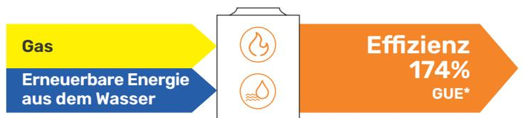
\*Der als GUE ausgedrückte Wirkungsgrad einer GAHP sollte nicht mit dem COP von elektrischen Wärmepumpen verwechselt werden. Um die Werte richtig vergleichen zu können, muss man den GUE mit 2,5 multiplizieren.
