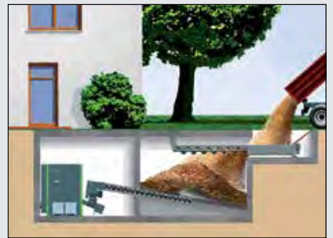
Beispiel: Lagerraum im Keller mit Einbringschnecke zur Befüllung über den Lichtschacht
