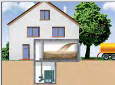
Beispiel: Pelletlagerraum mit Einblasvorrichtung
